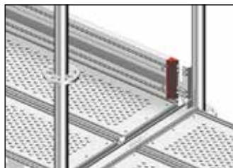
Rys. 50: Montaż krawężnika ze stali
