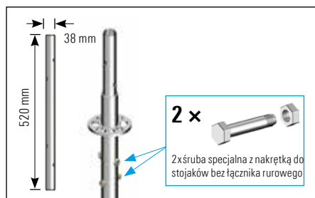
Rys. 31: Przymocowanie łącznika rurowego dwiema śrubami specjalnymi M12 x 60 z nakrętkami
