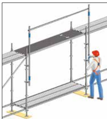
Rys. 14: Użycie poręczy wyprzedzającej w polu komunikacyjnym
