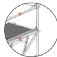
Rys. 96: Połączenie stojaków pionowych zawleczką
