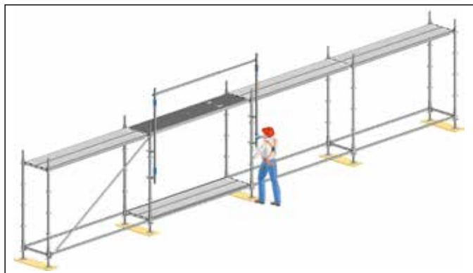
Rys. 14: Użycie poręczy wyprzedzającej w polu komunikacyjnym
