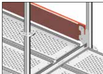
Rys. 49: Montaż krawężnika z drewna
