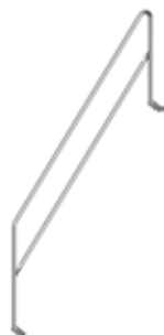
Poręcz wewnętrzna schodów T12 2.0 m wys., Nr art. 1752.007/008, do schodów 2.57 m i 3.07 m
