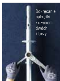
Rys. 32: Dokręcenie nakrętki z użyciem dwóch kluczy.
