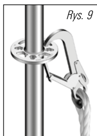
Rys. 9: Zaczepienie jest możliwe do dużego i małego otworu tarczy rozetowej (obowiązuje z Allround w wersji stalowej –nie dla aluminium)
